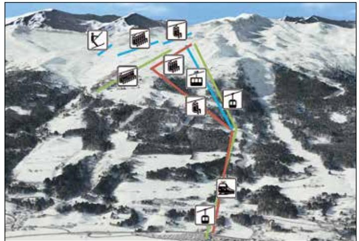
*Von den bisher acht Bahnanlagen werden drei gänzlich rückgebaut und eine weitere umgebaut. Zusätzlich kommt es zur Neuerrichtung einer Einseilumlaufbahn mit zwei Teilstrecken vom Parkplatz Schlossalmbahn über die Mittelstation im Bereich der Kitzsteinalm mit Durchfahrbetrieb zur Bergstation auf der Kleinen Scharte. (Bildquelle: Gasteiner Bergbahnen)*
